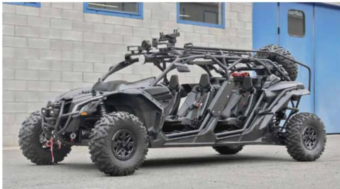
Il Light tactical all terrain vehicle in configurazione ruotata è un veicolo fuoristrada a quattro posti per impieghi speciali
